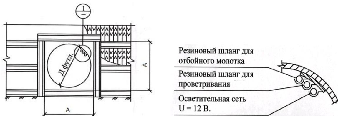
Рис. 2.6. Конструкция передней стенки котлована и схема расположения подводящих коммуникаций для работы на забое выработки. Сечение 2-2. М 1:500 (A=1,8м.).
