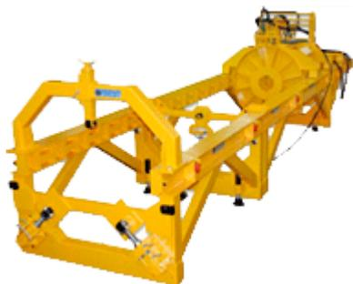
**PBA 200** - мощнейшая буровая установка шнекового бурения, применяется для прокладки стальных труб диаметром от 325мм до 1420 мм. Она может использоваться для всех видов бестраншейной прокладки и достигает длины прокладки до 120 м.
